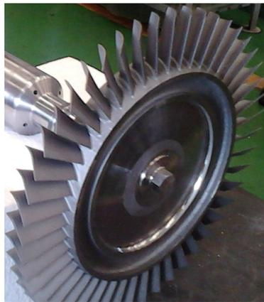
FIGURA 4.7: Rotor da Turbina.
