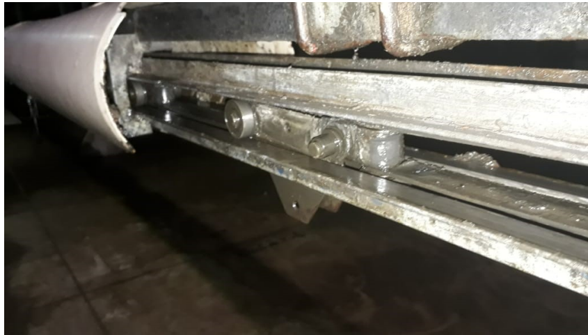
Figura 25 – Retirada do rolamento traseiro do elo menor para teste.
