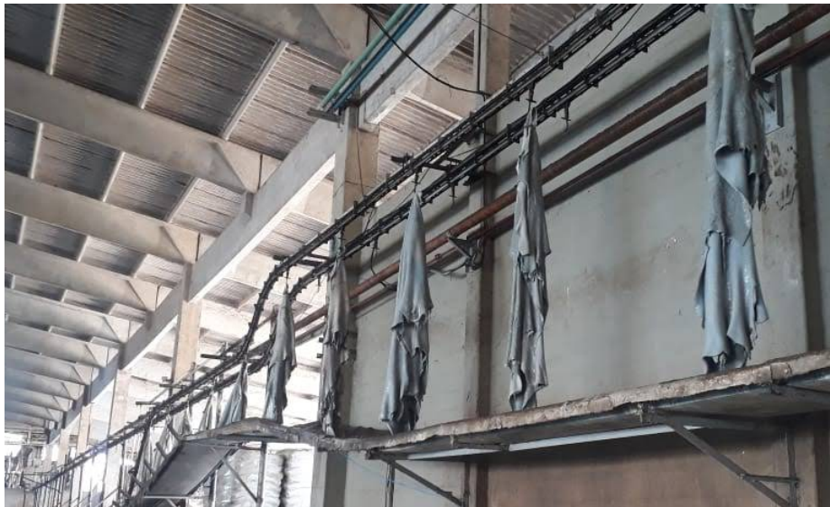
Figura 2 – Transportador aéreo de couros da unidade de Marabá.
