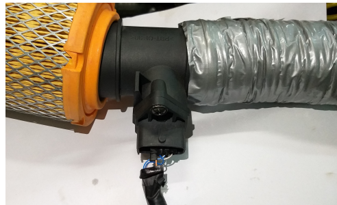
Figura 20 – Sensor MAF instalado no coletor de admissão.
