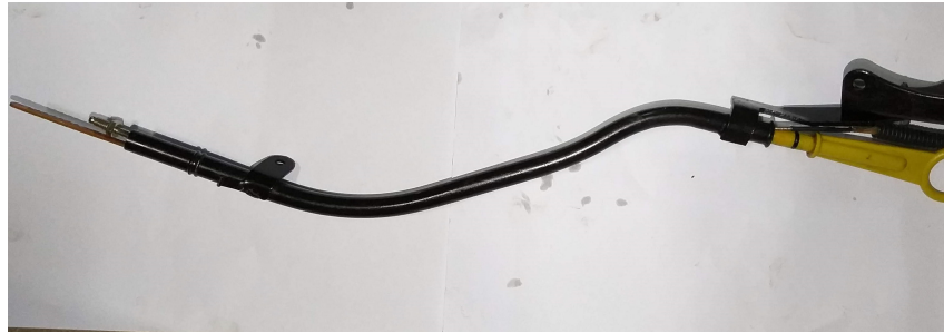
Figura 13 – Adaptação do termopar no cárter do motor.
