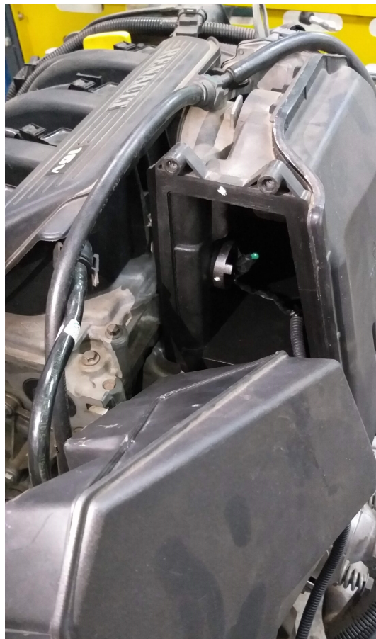
Figura 12 – Instalação do termistor no coletor de admissão de ar.
