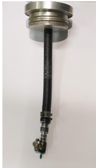
Figura 16 – Termistor colocado no tanque de combustível.
