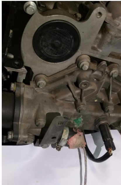
Figura 15 – Coletor de gases de exaustão com a instalação do termopar.
