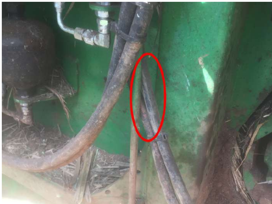
Figura 4.5 – Segundo modo de falha do componente - ausência dos espirais de proteção.
